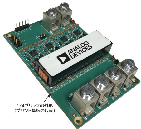
図5. 48Vから12Vへの降圧を担うレギュレータ。すべてのコンポーネントは、基板上面（1/4ブリックの外形範囲内）に配置されています。約1mmのコンポーネントをすべて背面に配置すれば、1/8ブリック・サイズに収めることができます。
